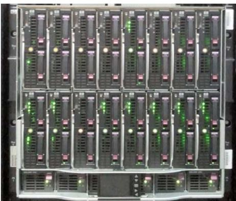
Ein Enclosure mit 16 Blades (oben) und 6 Netzteilen (unten), davor in der Mitte eine kleine Management-Konsole
