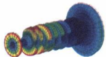
Schwingamplituden einer Kurbelwelle
