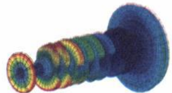
Schwingamplituden einer Kurbelwelle
