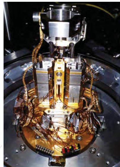
Tiefkalter Spektroskopieaufbau zur Untersuchung von quantenphototonischen Schaltkreisen und Quantenlichtquellen
