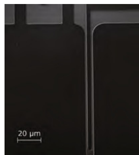
Mikrograph eines supraleitenden Detektors, der mit Laserlithographie strukturiert worden ist.
