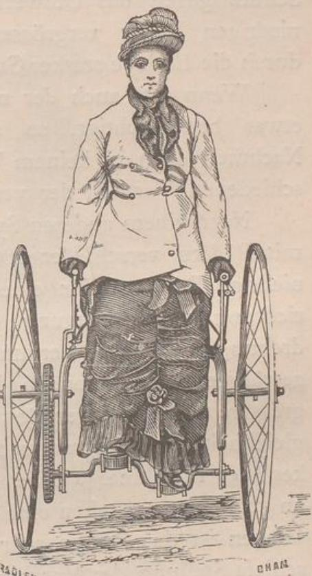
gewährt den Vortheil einer grösseren Sicherheit dieser Maschinen, indem der Schwerpunkt niedriger liegt als bei hohen Rädern, ohne die Breite des Dreirades zu vermindern, was allerdings ein grosser Schutz gegen das Umwerfen ist. Die durch die niedrigen Räder vergrösserte Erschütterung wird durch die Einlage starker Gummipolster aufgehoben.
