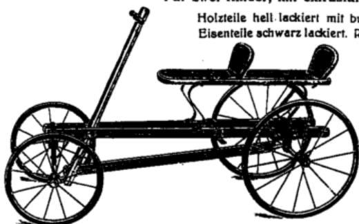
Nr. 503 Mit 1 Antriebshebel, zwei verstellbaren Rücklehnen. Radhöhe 30/40 cm. Metallräder. Sitzhöhe 45 cm. Sitzlänge 60 cm.
