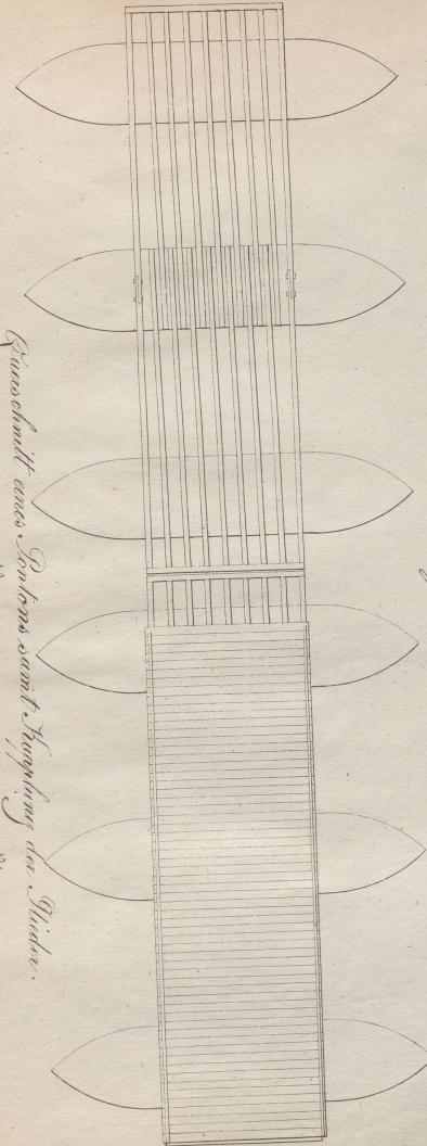
Grauschmied eines Pontons mit Anbringung der Glider.
