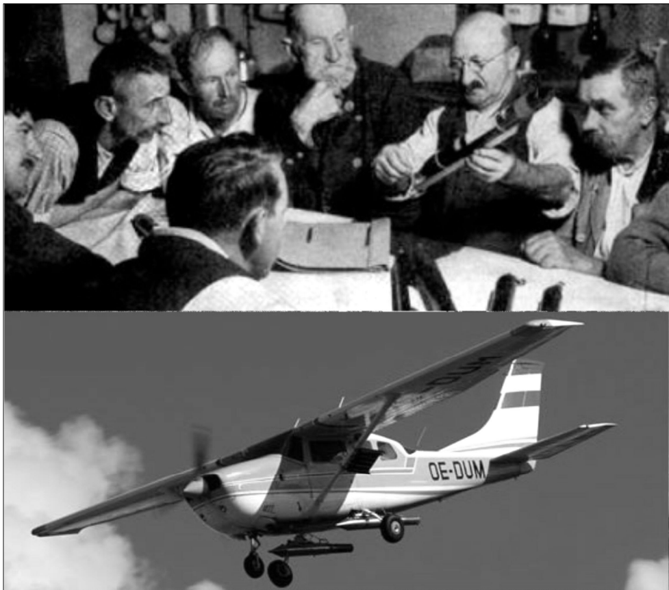
Abb. 5: „Genossenschaftliche Hagelabwehr“ in Südtirol im Wandel der Zeiten: Erste Silberjodid-Raketen (1950er Jahre) und moderner „Hagelflieger“ (1990er Jahre).
