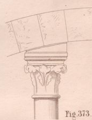
Unterstützung eines Strebebogens durch eine freistehende Säule.
