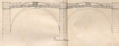
Volles Kreuzgewölbe mit Stichkappen auf vier Pfeilern. Dürchschnitt.
