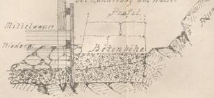
bei Fundierung im nassem Boden
