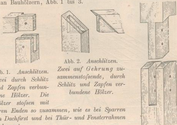
Abb. 3. Anschlitzten. Verlängerung eines Holzes durch ein anderes; beide sind verbunden durch Schlitz und Zapfen.
