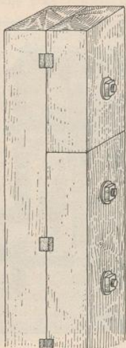
Abb. 7. Aufpfropfen. Verlängerung durch Schraubenbolzen und Keile.
