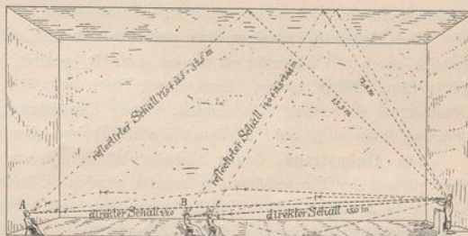
Abb. 2. Akustik. Mit wachsender Entfernung des unmittelbar an das Ohr gelangenden Schalles von der Schallquelle wird der Umweg des reflectirten Schalles kleiner. A ist von der Schallquelle 24 m entfernt. Der von der Decke reflectirte Schall hat einen Weg von 32,5 m, also einen Umweg von 8,5 m zurückzulegen. Bei B beträgt der Umweg 11,8 m bei einer Entfernung von 15 m von der Schallquelle.
