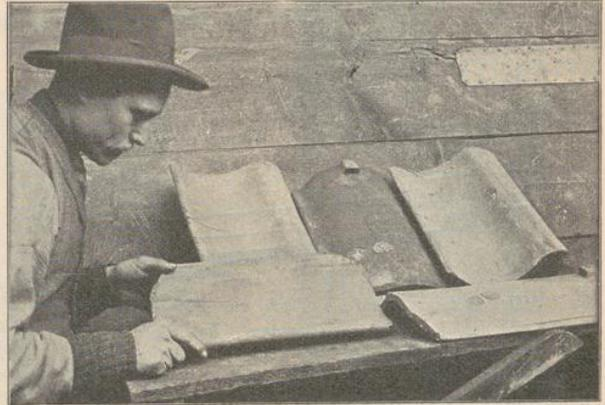
Abb. 5. Dachdeckung. Fehlerhafte, für die Verwendung nicht gut taugliche Ziegel. Der obere links und der in den Händen des Dachdeckers haben einen Riß; an den übrigen bemerkt man Kalkstückchen im Thone, durch deren nachträgliches Löschen die dünneren Ueberdeckungstheile abgesprengt sind, wodurch die Oberfläche gleichsam pockennarbig wird und der Ziegel alsbald verwittert.
