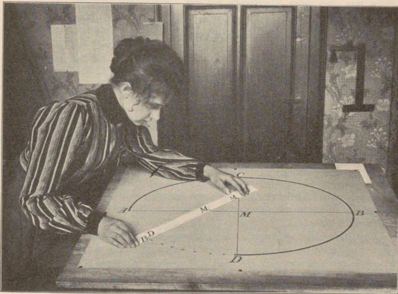
Abb. 3. Ellipsenzeichnung mittels Papierstreifens, auf dem die halbe große und halbe kleine Achse von demselben Punkte abgetragen sind; verschiebt man den Unterschied beider, also die Punkte M, auf den Achsen, so beschreibt der gemeinsame Punkt BD die Ellipse.
