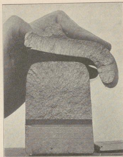
Abb. 3. Eisen. Hartgufs. Das obere Stück ist von einem in der Coquille gegossenen Wagenrade; das untere Stück ist in einer Eisenform gegossen. Bei beiden bemerkt man, dafs durch schnellere Abkühlung der Kohlenstoff zur Auskristallisierung nicht Zeit hatte; an den rascher erkalteten Flächen erscheint in Folge dessen der Bruch heller. Der untere Theil des unteren Stückes (unter dem dunkelen Striche) zeigt keine Bruchfläche, sondern eine Schnittfläche.
