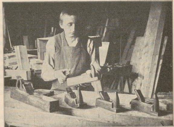
Abb. 2. Hobel. In den Händen des Tischlers ein Putzhobel; die rechte Hand hält das herausgenommene Doppelseisen mit dem daraufliegenden Keil zum Festkeilen und Einstellen des Eisens im Keilloche des von der linken Hand gehaltenen Hobelkastens. Rechts auf dem Bilde ein gewöhnlicher Schlichthobel, daneben ein kurzer Putzhobel. Links der Bankhobel, die Raubbank, zum Ebenen großer Flächen, daneben ein Schiffhobel. Dieser hat eine bogenförmige Sohle zum Bearbeiten gebogener (concaver) Flächen.
