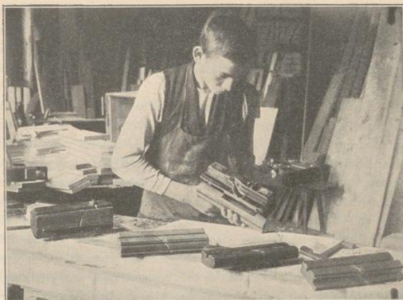
Abb. 3. Hobel. Sims- oder Profilhobel mit einem dem Profile eines Gesimsgliedes entsprechend geformten Eisen. Rechts ein Stabhobel, daneben Hohlkehelhobel, dann Hohlkehelhobel (Viertelkehle) mit Anschlag, links eine Plattbank zum Abplatteln der Füllungen. Das Eisen dieses Hobels ist schräg zur Hobelachse gerichtet, um auch rechtwinklig zu den Fasern eine glatte Fläche hobeln zu können, wie es für Füllungen meist nöthig ist. In der Hand des Tischlers ein Nuthhobel. Dieser hat zwei mittels Schrauben verstellbare Führungen, die eine, der Anlauf oder Ablauf, giebt die Tiefe der Nuth an, die andere, der Backen oder Anschlag, bestimmt die Entfernung der Nuth von der Kante des Arbeitsstücks.
