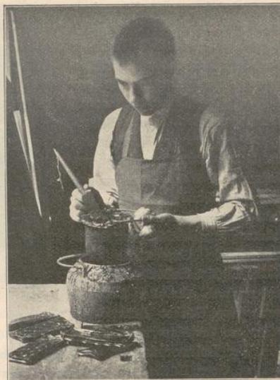
*Leim. Vorn Leimstücke, wie sie in den Handel kommen; dahinter in der Hand des Tischlers ein Leimtopf, der in einen Kessel mit Wasser eingesetzt wird, weil der Leim in einem unmittelbar auf Feuer gesetzten Topfe leicht anbrennt. Früher wurde der Leim freilich stets in einem dreibeinigen Leimtiegel über Feuer gekocht. In der Rechten hält der Tischler den Pinsel zum Aufstreichen; im Topfe steht vor dem Pinsel ein kleines Holzstück zum Umrühren.*
