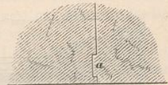
Abb. 62. Mauern. Verbindung zwischen Mauerwerk, welches sich verschieden setzt, z. B. zwischen altem und frischem, besser durch den Falz a als durch Verzahnung oder Abtreppung, weil sich die Theile dabei unabhängig von ein- ander setzen können.
