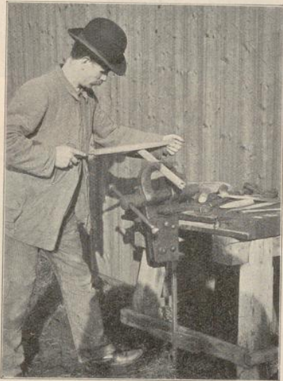
Schraubstock zum Festhalten eines Eisenrohrs, welches durchgefeilt werden soll.
