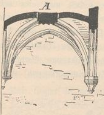
Abb. 1. Schlufsstein. Letnergewölbe mit Schlufsstein A in der Minoritenkirche zu Hörter von 1281.
