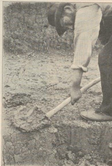
Thon zu Ziegeln, die Ziegelerde, wie sie gegraben wird, um nach dem Durchfrieren im Winter gereinigt und geschlämmt zu Ziegeln verarbeitet zu werden.
