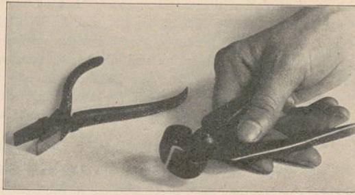
Zange. In der Hand die gewöhnliche Kneif- oder Beißzange; links eine Drahtzange, deren Angriffstheile auch cylindrisch bezw. kegelförmig sein können.
