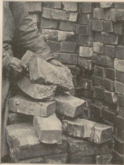
Abb. 2. Ziegel. Durch zu starken Brand zu Klinkern gesinterte Ziegel, die sich schief und krumm gebogen haben.
