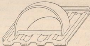
Abb. 7. Ziegel. Kaff- oder Froschmaulziegel, um Licht und Luft in den Dachraum zu bringen.
