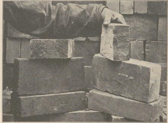
Abb. 3. Ziegel. Durch zu schwachen Brand nicht gar gebrannte blasse Steine, die im Bruche noch die einzelnen Körner ohne eine geringe Verglasung zeigen und daher nicht druckfest sind.
