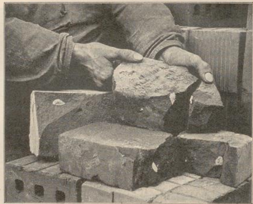
Abb. 4. Ziegel mit Kalktheilchen in die gebrannte Masse eingeschlossen, wodurch die Steine, wenn diese Theilchen sich im Laufe der Zeit lösen, zerspringen.
