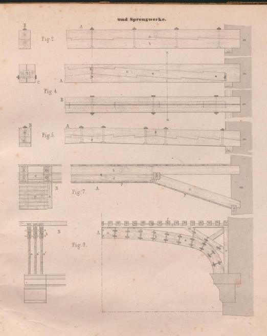
Fig. 5. A, B, Ansicht und Profil eines Sprengbalkens, der aus 5 Balkenstücken zusammengesetzt ist, die in s s in Dreieckform sowohl nach oben, als auch nach unten gegen einander pressen. Einer dergleichen Verbindung mehrerer Hölzer bedient man sich dann, wenn die Längen der einzelnen Balkenstücke zu gross, folglich auch zu schwach werden würden, was meist in solehen Fällen geschieht, wenn hinlänglich starkes Holz mangelt.
