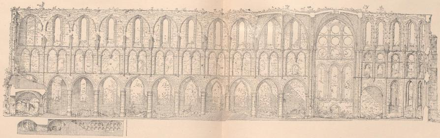
Abb. 106. Längsschnitt durch die Kirche, Blick nach Süden. Zustand 1915. 1:200.
