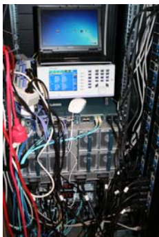
Energieverbrauchsmessung an der VDI-Testinstallation
