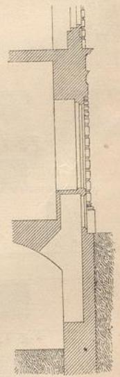
(Fig. 136). Hierdurch, durch die eingeschlossene Lage und hohen Dächer, wird der Luftwechsel verhindert und das Licht in nicht geringem Grade beeinträchtigt; es werden deshalb die Seitenwände sehr hell gehalten; insbesondere aber darf die Grundfläche, bzw. der Querschnitt nicht zu gering, für einen Lichtschacht nicht unter 2 bis 5 qm, für einen Lichthof nicht unter 10 qm bemessen werden.
