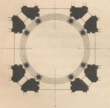
ausnahmsweise vorkommende elliptische Form wird durch eine ihr nahe kommende, aus Kreisstücken zusammengesetzte, wohl auch durch gerade Linien verlängerte Figur ersetzt werden können.
