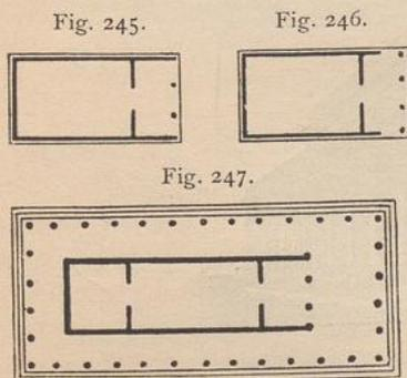
Es mag hier, unter Hinweis auf Fig. 245 bis 247, die Bemerkung genügen, daß die Vorhalle, mit dem Tempelraum unter ein Dach gebracht, theils nur an einer, theils an jeder der beiden Schmalseiten vorkommt, theils aber auch an den Langseiten herumgeführt ist. Nach Fig. 245 erhält sie mehr den Charakter des Abgeschlossenen; nach Fig. 246 u. 247 ist sie eine offene Halle.
