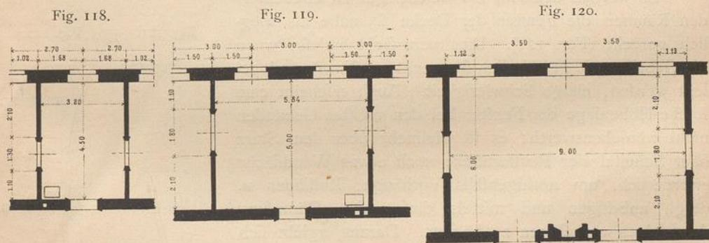
bis 1,8 m zu rechnen ist, so ergibt sich nach Fig. 104 eine Tiefe von 4,5 m, nach Fig. 119 eine solche von 5,0 m. Ob hierbei die Thür näher an die Fenster- oder an die Rückwand zu setzen ist, hängt davon ab, welcher Theil der Scheidewand bei Tage besser erhellt sein soll. Auch die Gewohnheiten des Landes sind darauf von Einfluss. Soll aber die Thür in die Mitte der Wand zu stehen kommen, so ist nach Fig. 120 eine Tiefe von 5,5 m, bezw. eine solche von 6,0 m erforderlich.
