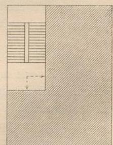
denfelben nur nach zwei Richtungen stattfinden. Dennoch wird diese Anordnung in französischen Grundrissen mit Vorliebe auch für die Haupttreppen größerer Gebäude getroffen, weil sie es ermöglicht, die Fenster über dem Hauptruheplatz, also in gleicher Höhe mit den übrigen Fenstern des Geschoßes, heranzuführen.
