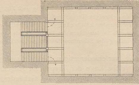
Den gleichen Vortheil würde die Lage nach Fig. 302 und zugleich, wie in Fig. 301, den ununterbrochenen Zusammenhang sämtlicher Räume gewähren. Sie hat aber den Mifsstand, dafs rings um das Treppenhaus Verbindungsgänge angelegt werden müssen und dadurch nicht allein viel Platz beansprucht wird, sondern auch ein weiter Weg zurückzulegen ist, um zu den rückwärtigen Räumen zu gelangen.
