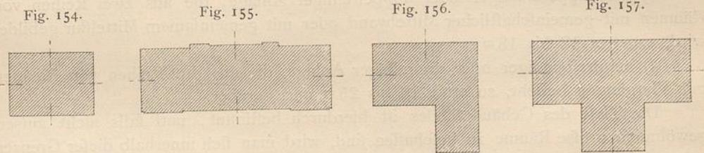
um dadurch nach Früherem bessere Maßverhältnisse für die Fasadengestaltung zu erlangen. Hierbei ist darauf zu achten, daß diese vorspringenden Baumassen entweder entschieden breiter oder schmaler als die zurückliegenden Wandflächen werden. Annähernd gleiche Theilung bringt Einförmigkeit, gar zu häufige Vor- und Rücklagen, bei verhältnismäßig geringen Abmessungen, eine unruhige Wirkung hervor.
