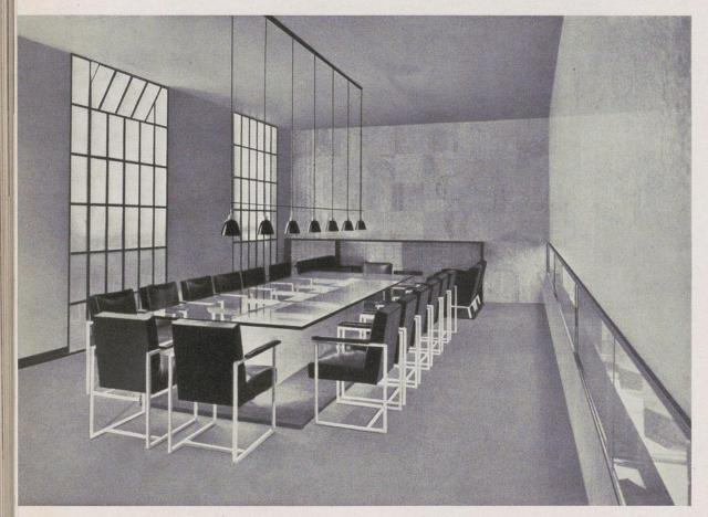
Neuerdings versucht man auch mit Erfolg noch eine Steigerung der gedämpften Helligkeit durch Glas als Wandbekleidung an Stelle von Papier- und Stoffbespannung und Bemalung; ja auch als Deckenbekleidung, die das aus hochgezogenen Fenstern einfallende Tageslicht in den Raum zurückstrahlt. Eingebaute Glasschränke werden die Raumwirkung vergrößern, weil sie keine Bodenfläche des Raumes mehr beanspruchen<sup>1</sup>).
