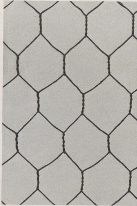
Drahtglas mit sechseckiger Netzeinlage.
