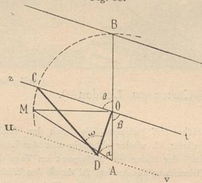
in Fig. 67 ist  $OBD$  bei  $O$  rechtwinkelig; daher ziehe man in  $O$  eine Linie senkrecht zu  $zt$ , bis diese in  $D$  die durch  $A$  parallel zu  $zt$  gezogene Gerade  $uv$  trifft. Macht man nun  $OC = OM = OB$  und zieht man die Linie  $CD$ , so entspricht das Dreieck  $OCD$  dem um  $OD$  in die wagrechte Ebene umgelegten Dreieck  $OBD$  in Fig. 67; daher ist der Winkel  $ODC$  der gefuchte Winkel  $\omega$ .
