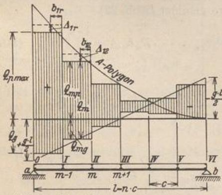
Abb. 69a. Schaubild für max Om aus Eigengewicht und einem Lastenzug als Verkehrslast.
