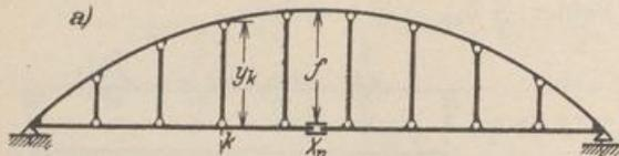
Stützweite:  $l = (n-2)c$ , Abszissen des Punktes  $k$ :  $(k-1)c, (n-1-k)c$ .
