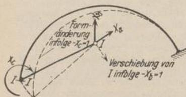
Abb. 233.  $\delta_{ab} = 0$ ;  $\delta_{ac} = 0$ ;  $\delta_{bc} = 0$ . Die Nebenbedingungen bedeuten kinematisch, daß  $X_b \perp \vec{bb}'$  infolge  $-X_a = 1$  ist und die Wirkungslinien von  $X_a$  und  $X_b$  durch den Pol der elastischen Bewegung der Endtangentialen in  $I$  infolge von  $-X_c = 1$  verlaufen.
