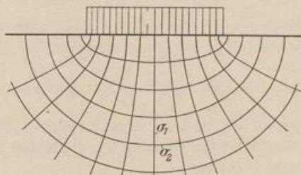
Abb. 719 b. Längsspannungstrajektorien.
