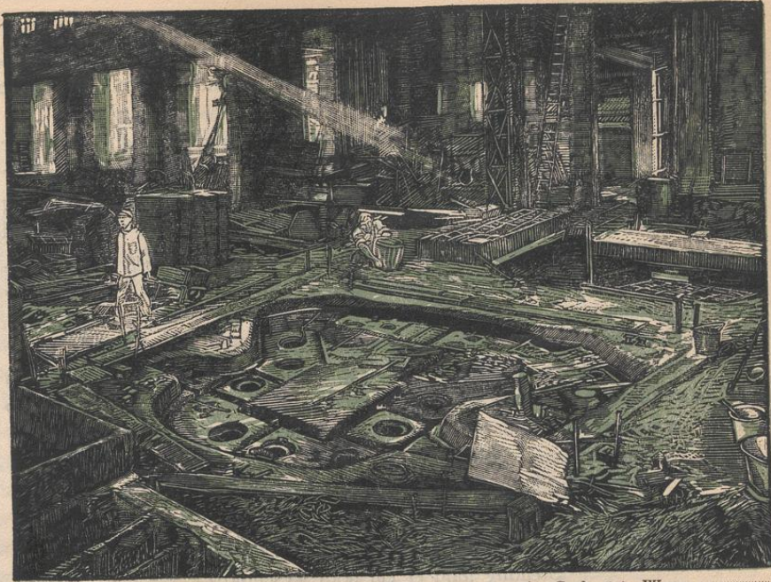
Abb. 62. Das Einformen eines großen Walzenständers in der Gießerei in Wetter.
