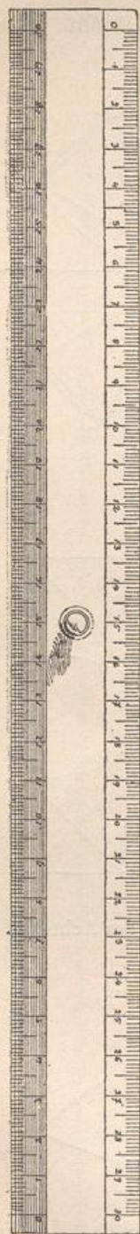
Fig. 10. Maßstablineal aus Buxholz. \frac{1}{2} natürl. Gröfse.
