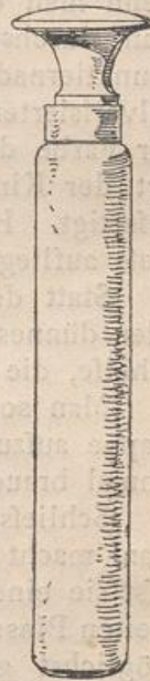
Fig. 53. Instrument zum Durchreiben von Zeichnungen.
