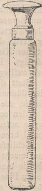
Fig. 53. Instrument zum Durchreiben von Zeichnungen.
