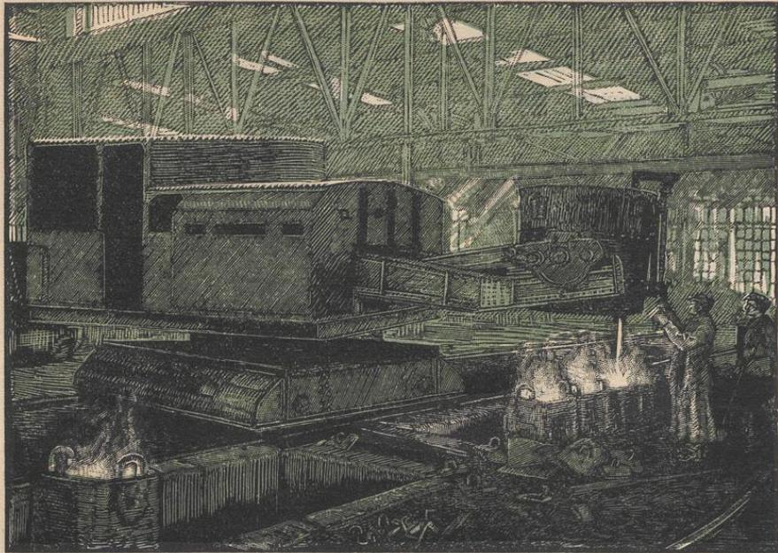
Abb. 83. Neuzeitiger rein elektrischer Stahl-Gießwagen.
