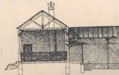
Querschnitt durch das Klassengebäude.
