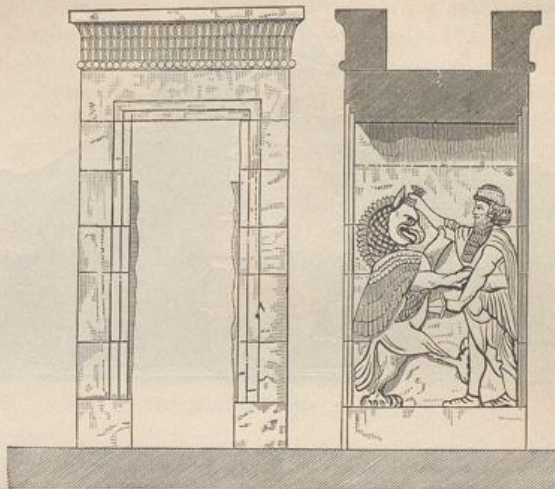
Figur 41. front und Durchschnitt eines Seitenportals der Hundertsäulen-Halle.
