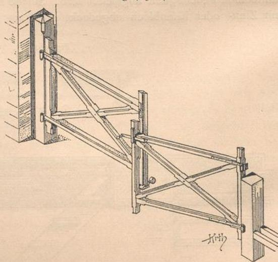
Gewöhnlich öffnet sich die Barriere nach einer Seite, und dann ist die Construction die in Fig. 463<sup>126)</sup> dargestellte, woraus auch die Art des Beschlages zu entnehmen ist.
