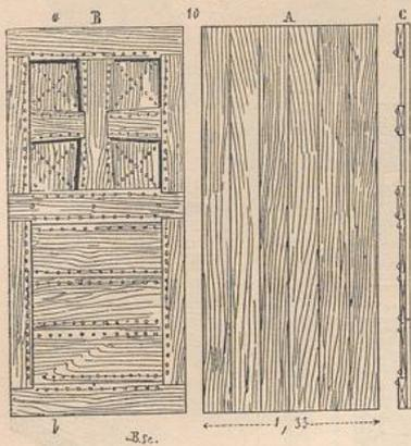
der langen Bänder an dem Gerüst und den Brettern auch schon eiserne Nägel verwendet. Auch wird der hölzerne Riegel in eine eiserne Gabel gelegt<sup>98)</sup>.
