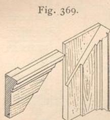
leisten des Zimmers entspricht (Fig. 371); Abchrägungen bewirken, daß der Sockel sich den Gliederungen der Bekleidung möglichst anschließt. In Zimmern mit besseren Fußböden werden die Thürfutter u. f. w. vor dem Verlegen der ersteren eingesetzt, sonst nachträglich. Die Sockel werden in folchem Falle bis nach Fertigstellung der Fußböden fortgelassen. Die Bekleidung erhält gewöhnlich eine Breite von 13 bis 15 cm, also etwa gleich  $\frac{1}{7}$  bis  $\frac{1}{8}$  der Thürweite.
