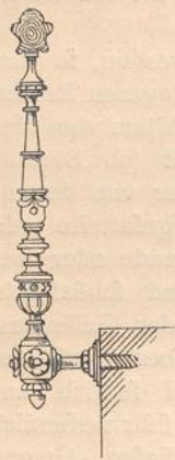
Geländerstab mit Krücke. \frac{1}{20} w. Gr.
