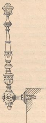
Geländerstab mit Krücke. \frac{1}{20} w. Gr.
