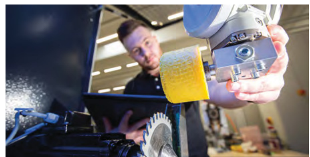
Hand angelegt wird nur noch zum Prüfen: Düspohl setzt auf vertrauenswürdige künstliche Intelligenz, um einen bisher rein händischen Schleifprozess zu automatisieren.
