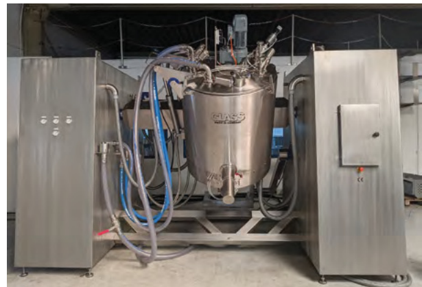
Endmontage eines Mischsystems bei der Firma GLASS Final assembly of a mixing system at GLASS
