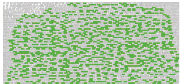
Registerzellen der 31 32bit-General-Purpose-Register des Freedom-E300 (grün markiert)
