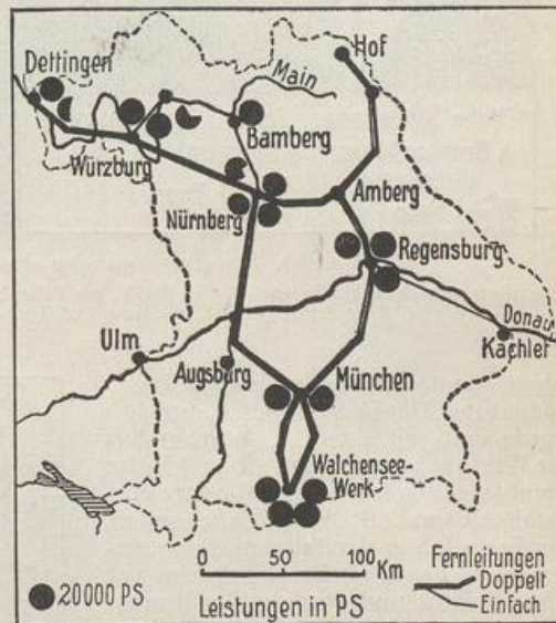
334. Das Kraftnetz Bayerns. Es wird auf das Walchenseewerk und die bayerischen Flüsse aufgebaut.
