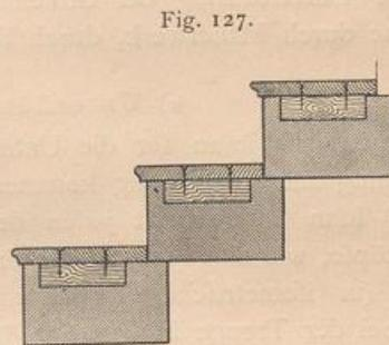
Um ein sanfteres Begehen der Steinstufen zu ermöglichen, wird bisweilen auf deren Trittfäche ein Holzbelag angebracht. Dies kann in der durch Fig. 126 u. 127 veranschaulichten Weise geschehen. Hiernach werden auf in den Stein eingegypste Holzklötze oder -Dübel die Belagsbohlen aufgeschraubt, und zwar mit
