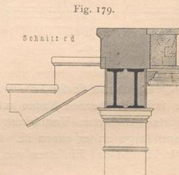
hergehenden Stufe lagert und im Uebrigen in die Treppenhausmauer eingemauert ist. Eine Ausrundung oder Abchrägung der Treppenhauscken nach Art von Fig. 176 ist dabei ganz zweckmäfsig, weil die Absatzplatten dadurch einen erhöhten sicheren Halt bekommen; die Gröfse des Ruheplatzes wird hierbei nur scheinbar verringert, da jene Ecken nur in den allerfeltesten Fällen betreten werden.
