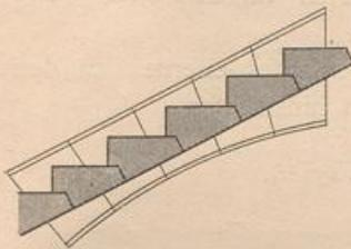
Bisweilen hat man sie aus verhältnismäßig vielen und kleinen Stücken zusammengesetzt, wobei sie alsdann nach Art der Wölbsteine geformt und zu einer Art Mauerbogen zusammengefügt werden (Fig. 147).
