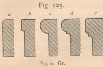
Wenn Treppen keinen Anspruch auf hübscheres Aussehen machen, so wird deren Vorderkante um ein Geringes gebrochen. In reicher ausgestatteten Gebäuden hingegen erhalten die Stufen einfachere oder reichere Profilierungen, von denen in Fig. 125 a bis e die gebräuchlichsten dargestellt sind. Man lasse solche Profilierungen nicht scharf ausladen, sondern gebe ihnen eine thunlichst rundliche Form, damit dem sonst leicht vor-
