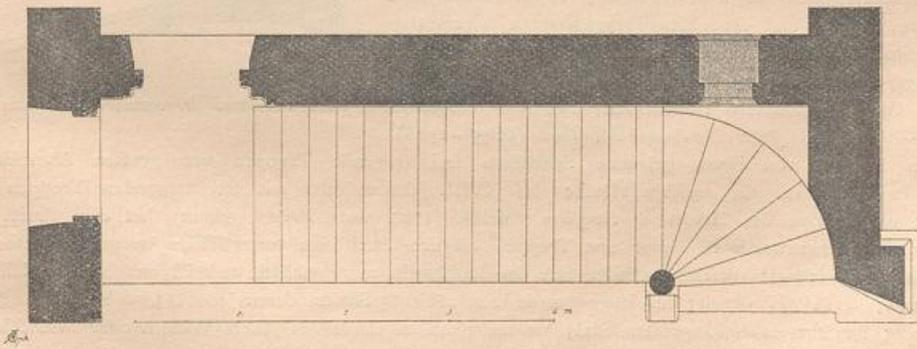
An der äusseren Treppenhausmauer wird wohl auch nur ein hölzerner Handläufer angeordnet, der in geeigneter Weise durch eiserne Haken etc. befestigt wird; Fig. 161<sup>43)</sup> u. 162<sup>44)</sup> zeigen eine einschlägige Construction.
