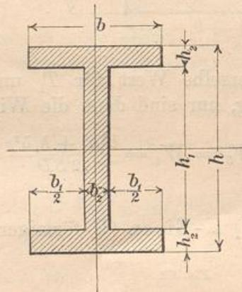
53)  $\Gamma$ -Träger (Doppel-T-Querschnitt). Figur 59.
