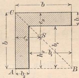
58)  $\Gamma$ -Eisen (gleichschenkliges Winkeleisen). Fig. 64.
