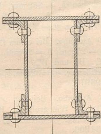
Sind die Querschnitte nicht einheitlich, sondern in ihren Teilen durch Niete mit einander verbunden, so ist darauf zu achten, daß mindestens der Einfluß der Nietlöcher berücksichtigt werden muß. An einigen der Zeichnungen ist dies angedeutet. Bei Gurtungen, die große Entfernungen von der neutralen Achse haben, kann der
