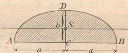
Zweite Form. Für  $AB$  ist  $T' = \frac{a b^3 \pi}{8}$ , nach Nr. 12) ist  $h_s = \frac{4b}{3\pi}$ , also folgt für die horizontale Schwerpunktsachse
