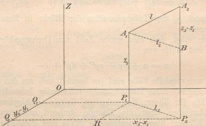
**Auflösung.**  $P_1$  und  $P_2$  seien die Projektionen der Punkte  $A_1$  und  $A_2$  auf die Grundebene,  $Q_1$  und  $Q_2$  die von  $P_1$  und  $P_2$  auf die  $Y$ -Achse, ferner sei  $P_1R \parallel Q_1Q_2$ ,  $A_1B \parallel P_1P_2$ , dann ist
