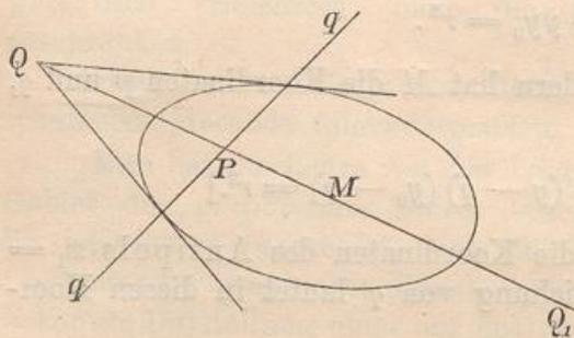
**Auflösung.** Man ziehe (Fig. 200) eine beliebige Sehne parallel zu  $q$  und verbinde ihren Halbierungspunkt mit  $M$ . Dies gibt den konjugierten Durchmesser  $MP$ . Von  $P$  aus lege man Tangenten an die Ellipse. Die Verbindungslinie der Berührungspunkte gibt den Schnittpunkt  $Q$ . Man mache  $MQ_1 = MQ$ , dann ist  $Q_1$  der Antipol.
