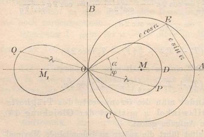
Dies führt zu folgender Konstruktion für den Radius des Centrifugalmomentes für gegebenen Winkel  $\alpha$  und  $\alpha - 90^\circ$  und bei gegebenem Maximal-Radius  $\varrho_1$  und Minimal-Radius  $\varrho_2$ .
