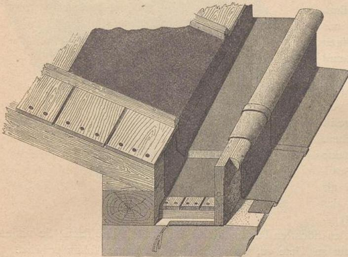
des vorliegenden Heftes verwiesen. In ähnlicher Weise läßt sich der Abfuß für das Anbringen der Rinne dadurch herstellen, daß unter die eigentlichen Sparrenköpfe kurze Unterschiebblinge gebolt werden, an welche die gekehlten Sparrenköpfe anzuschneiden sind.
