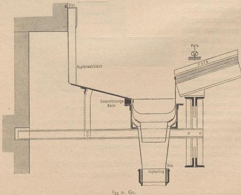
sonst warm liegt, so daß die im Inneren des Rohres aufsteigenden warmen Dünfte das Einfrieren des Einfalltrichters verhindern. Nur die sog. *Knoblauch'sche Rinne* bildet eine Ausnahme. Diese muß ihrer ganzen Länge nach in einem durchwärmten Raum untergebracht sein, soll sie nicht durch Eis und Schnee verstopft werden. Bei einzelnen Dach-Constructionen, so z. B. bei *Shed*-Dächern, lassen sich die Kehl-rinnen überhaupt kaum vermeiden.
