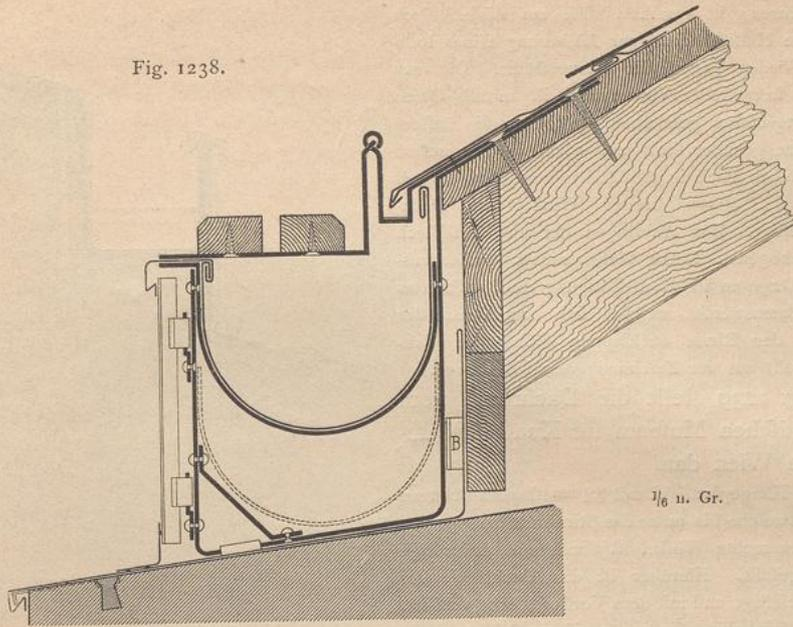
und zugleich ohne Lötung mittels einer Oefe mit dem Traufblech zu verbinden. Der Haft *a* wird nach Fig. 1233<sup>261</sup>) um den Falz *i* des Rinnebleches gebogen, der übrigens, wie aus Fig. 1229 hervorgeht, auch häufig fehlt. Das unterste Blech der Dachdeckung greift gleichfalls in diesen Falz ein.
