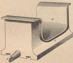
Zu dem im gleichen Hefte (Art. 233, S. 365) über die Rinnen aus Dachpappe Gefagten ist hinzuzufügen, dass diese Rinnen sich bei solider Ausführung häufig sehr gut gehalten haben. Dieselbe muss in der Weise erfolgen, dass zunächst eine etwa 1 m breite Lage von Leinentoff, welcher eben so, wie die Asphaltpappe, mit
