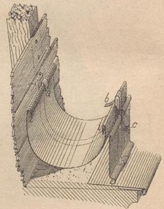
Abdeckung gelöthete Kupferhafte halten den Wulft fest; außerdem ist aber die Wand durch messingene Schrauben *g* an den eisernen Stützen befestigt. Dünne, kurze Röhrchen liegen zur Versteifung in den Wulften da, wo zwei Bleche an einander stoßen. Zwischen Vorderwand und Abdeckung ist ein Zwischenraum von etwa 5 mm, der durch das Aufliegen der Schiebefalze auf einander entsteht.
