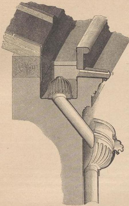
der Dachrinnen. Die äußere Rinnenwand ist durch das Ueberflusrohr *b* durchbrochen, welches bei Verstopfungen in Thätigkeit tritt. Das Zerlegen des Abfall-
