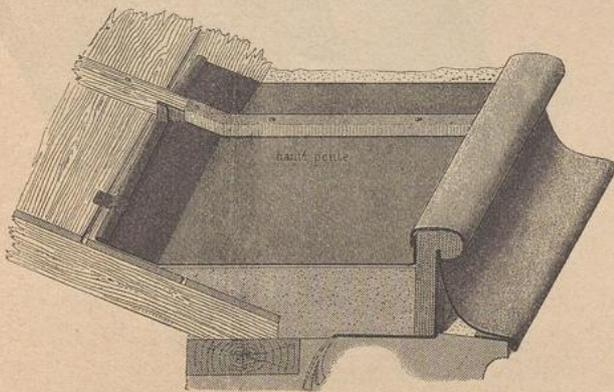
Die Abdeckung ist hierbei von sehr starkem Zinkblech, die eigentliche Rinne von Kupferblech hergestellt. Bei etwaigem Undichtwerden der Rinne wird das Leckwasser durch Oeffnungen im Balustraden-Sockel über die Traufkante des Hauptgefusses abgeführt.
