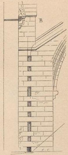
durch Anbringen feinerer oder hölzerner Traufrinnen, sodann durch Errichtung einzelner hohler Steinfäulen zu verhindern, welche mit dem Gebäude in keinerlei Zusammenhang standen und oben mit einem Einfalltrichter versehen waren.
