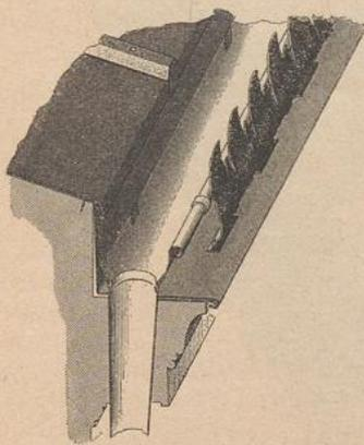
In Fig. 679 (S. 352) des mehrfach gedachten Heftes ist die Verankerung einer solchen Hängerinne dargestellt, welche sich eben so, wie die ebendafelbst in Art. 211 (S. 350) beschriebene, schwer lösen läßt, wenn eine Ausbesserung der Rinne das nöthig machen sollte. Fig. 1225 zeigt dagegen eine sehr empfehlenswerthe Anordnung nach dem Vorschlage *Schmidt's*<sup>260)</sup>, welche ein Herausnehmen und Wiedereinlegen der Rinne gestattet, ohne die geringste weitere Ausbesserung zu verursachen.
