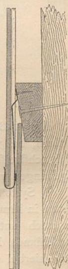
ende hakenförmig umgebogen wird. Jede Platte wird demnach an der unteren Kante durch den Haken, an der oberen Hälfte durch die darüber liegende Tafel fest gehalten. Dies und die geringe Dicke des Blechstreifens, durch welchen die sich deckenden Platten nur wenig von einander getrennt werden, ist ein Vorzug gegenüber dem früher genannten *Gérard'schen* Verfahren, eben so wie die Leichtig-
