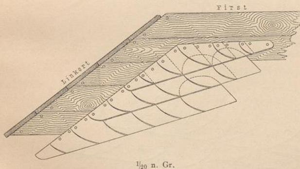
In Fig. 171<sup>38)</sup> ist der Anschluss eines Grates an eine höhere Dachfläche dargestellt, bei welchem sich zwei Kehlen bilden, welche beide links gedeckt sind.
