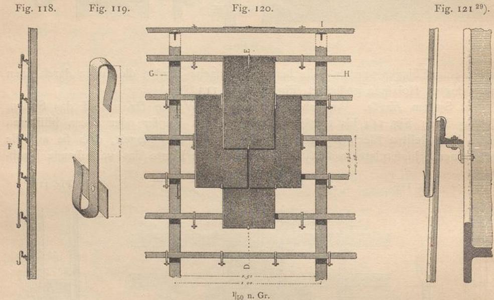
Fig. 118 bis 121<sup>29)</sup> zeigen die Anwendung dieses Systemes bei eisernen
