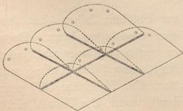
Fig. 140<sup>37)</sup> zeigt eine an manchen Orten gebräuchliche, von der gewöhnlichen abweichende Form der Decksteine, bei welcher im Außenren nur gerade Kanten zu sehen sind.
