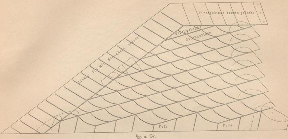
Fig. 165 bis 170<sup>38)</sup> zeigen die Einzelheiten eines Walmdaches, also die Anordnung der Schiefer an den Graten, und zwar sowohl mit Linkort- und Stichsteinen, wie mit Strackort, einmal an der Walmseite, wo die Dachfläche oben in einer Spitze endigt, dann am Anchluss der längeren Dachseite an das Firstgebände.
