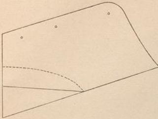
Stichstein ersetzt, wodurch der tiefste Punkt des Ortfeines verlegt und die größte Wassermenge auf den tiefer liegenden Ortfein geleitet wird. Die Deckung mit linkem Strackort, wie sie Fig. 135 u. 142 zeigen, ist nicht empfehlenswerth, weil das an der schrägen Kante der Deckgebände herablaufende Wasser zu leicht unter die Strackortfeine und danach in den Dachraum dringen kann. Fig. 162 u. 163<sup>37)</sup> stellen den Rechtsort- und den Stichstein bei einer Eindeckung von rechts nach links dar.
