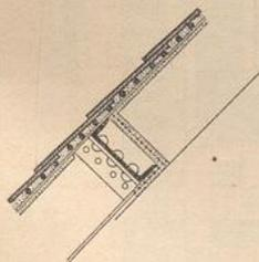
die unterste Drahtlage diejenige Stelle erhalten, die ihr statisch in der Dachplatte anzuweisen ist, wenn dieselbe so viel als möglich gegen Biegung fest sein soll. Indes kann die dreifache Ueberkreuzung so eingerichtet werden, daß ein Mehraufwand an Eisenmaterial und somit eine Vertheuerung der Dachfläche nicht nothwendig wird.
