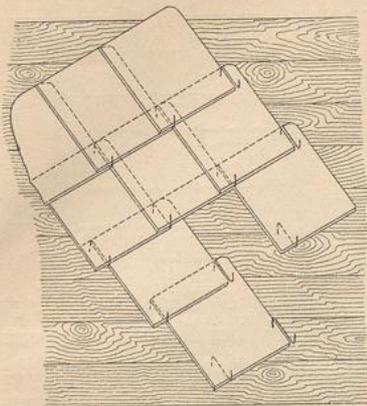
Schieferkanten entlang ziehende Waffer vom tiefsten Punkte auf die Mitte des darunter liegenden Steines abgeleitet wird, ist das System *Fourgeau* nach *Wankel*<sup>34)</sup> anwendbar. Derselbe sagt darüber:
