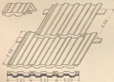
Die Doppelfalzziegel der Cementfabrik Germersdorf bei Guben, Patent *Wuttke*, haben große Ähnlichkeit mit den später zu beschreibenden schweizer Parallel-Falzziegeln, nur daß die Falzung eine doppelte ist. Fig. 231 zeigt den Dachstein, Fig. 230 einen Firstziegel.
