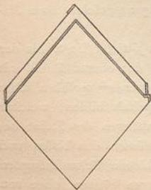
Eben so gleichen die Cementplatten von *Hüfer & Co.* in Obercaffel und von *Maring* in Braunschweig (Fig. 226 u. 227) im Wesentlichen den zuerst beschriebenen. Die rautenförmigen Steine sind am oberen und seitlichen Rande mit einem 8 mm hohen Leiftchen versehen. Das durch den Wind heraufgetriebene Wasser wird von diesem Randleiftchen zurückgehalten und fließt zurück; außerdem wird aber durch den Hohlraum zwischen beiden
