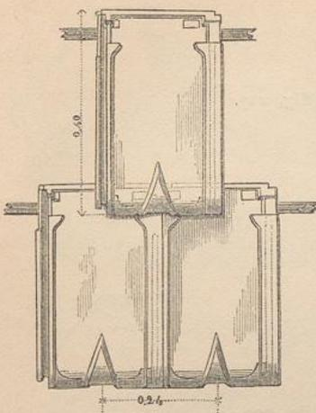
eifernen Holzschrauben auf den Sparren oder Pfetten befestigt, welche, von Mitte zu Mitte gerechnet, 50 cm von einander entfernt liegen müssen. Die Schraubenlöcher sind mit einem Kite aus Wasserglas mit Schlemmkreide zu dichten. Zum Abdecken der Firfte werden besondere Dachfirftziegel aus Magnest in Längen von 1,0 m angefertigt.
