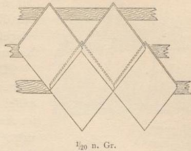
einander bedeckenden Platten verhindert, daß sich das Wasser durch die Anziehungskraft der Flächen heraufziehe. Dies ist ein Uebelstand, der sich z. B. häufig bei den gewöhnlichen Flachziegeldächern zeigt, bei denen die Platten dicht auf einander liegen. Die kurze feilliche Stosfuge ist zickzackförmig abgesetzt, zum Schutz gegen das Eintreiben von feinem Schnee.
