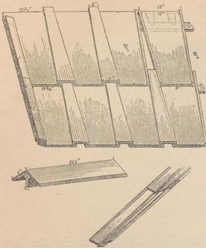
gestellt. In Staudach hatte man, wie bereits oben erwähnt, mit den trapezförmigen Steinen schlechte Erfahrungen gemacht, besonders auch bei den Transporten der Steine, bei welchen die Ränder derselben leicht Beschädigungen ausgesetzt waren, wodurch die Platten unbrauchbar wurden.
